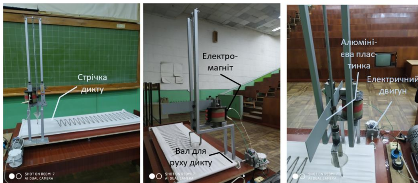
Рис. 6. Зовнішній вигляд установки для дослідження коливань фізичного маятника та вихрових струмів Фуко
