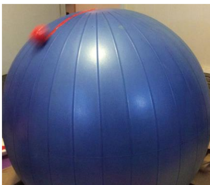
Рис. 2. Маленька кулька вивільняється з верхньої частини м'яча, залишаючи видимий слід від фарби, який можна виміряти.
