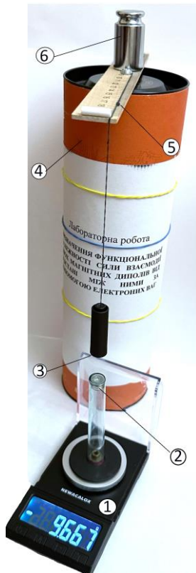
Рис. 1. Фото дослідницької установки: 1 – електронні терези, 2 – магніт №1, 3 – магніт №2, 4 – паперовий тубус, дерев'яна лінійка міліметрова, 5 – вузол на нитці, 6 – тягарець
