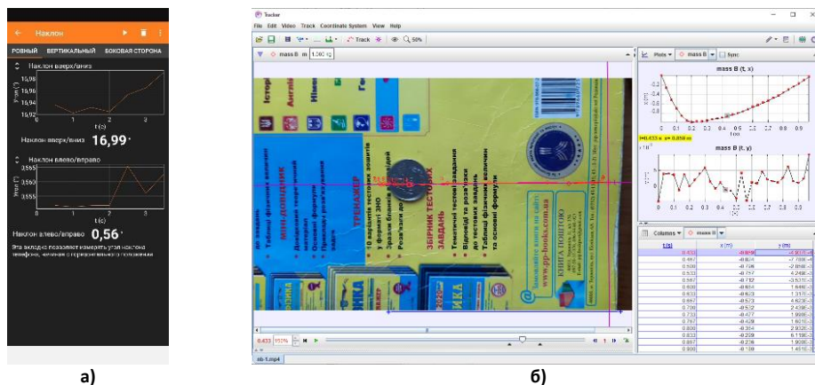
Рис. 6. Приклад застосування програми Tracker а) визначення кута нахилу площини; б) знімок екрану програми Tracker ( https://youtube.com/shorts/BtKueLsE5k0?feature=share )
