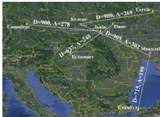
Рис. 1. Радіотраси мережі реєстрації метеорних явищ ( D – довжини (км) і A – азимуті (градуси) радіотрас)
